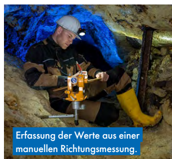
Polygonzugmessung untertage mit optischem Messgerät, das auf einen Vermessungsfixpunkt zielt.
