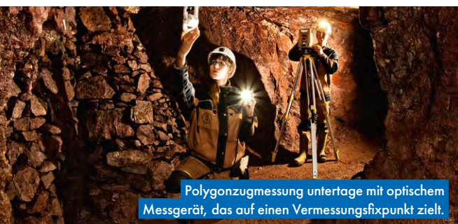
Erfassung der Werte aus einer manuellen Richtungsmessung.
